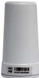
UA32天线是专为GPSL1/L2, 北斗B1/B2, GLONASSG1/G2和L-Band设计的高性能有源宽频带螺旋天线，可应用于无人机高精度卫星导航。天线采用寄生螺旋技术实现双频覆盖，该技术提供良好频率带宽和极化轴比，天线具有出色的滤波和抗干扰性能。天线配有O型密封圈，防护等级IP67。
